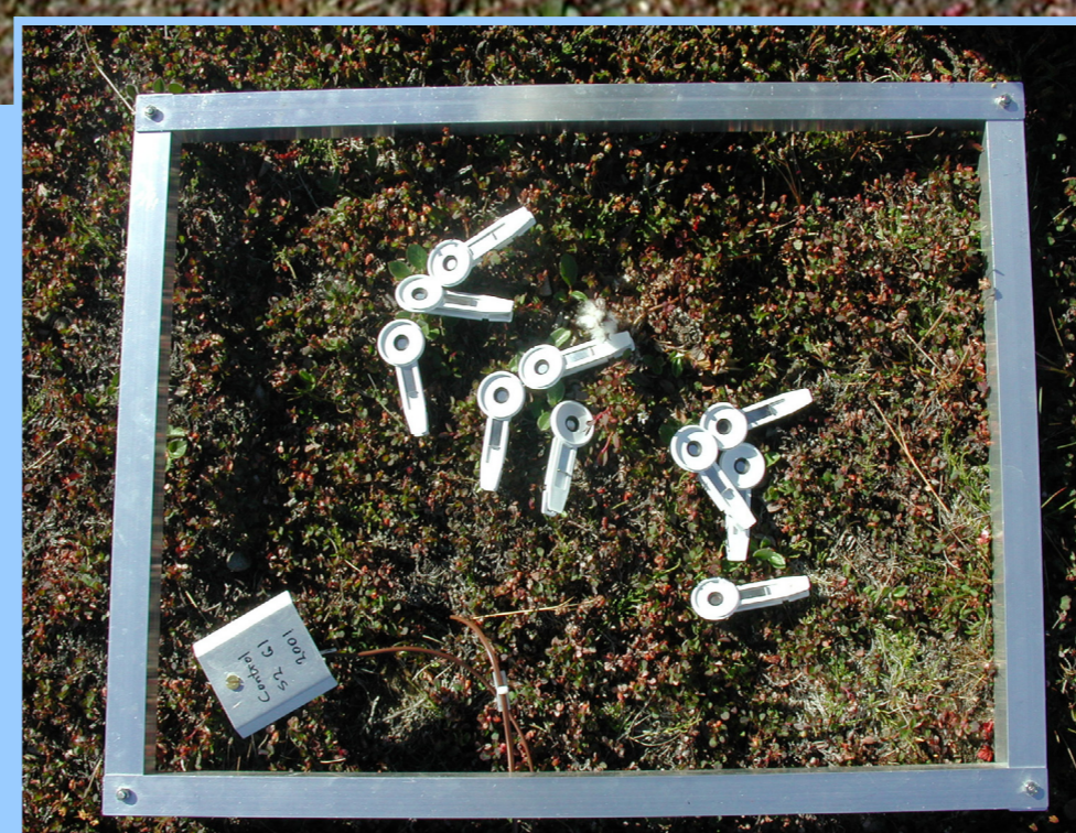
Figur 2. De hvide klemmer sættes på bladene for at mørke-adaptere dem inden måling af klorofylfluorescens.
